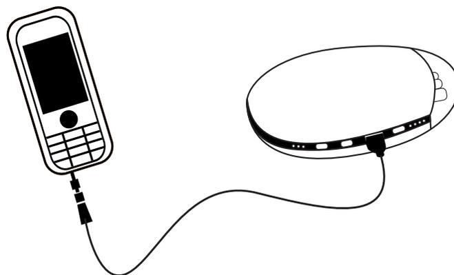
**Note :** Sortie USB 5V pour une charge automatique on/off
